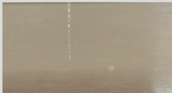
Spannungsrisse auf einer Acrylat (PMMA) Oberfläche, verursacht durch lösemittelhaltige Reinigungsmittel
