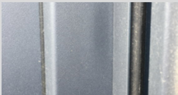
Glanzstelle durch falsche Reinigung einer matten Dekoroberfläche © profine GmbH
